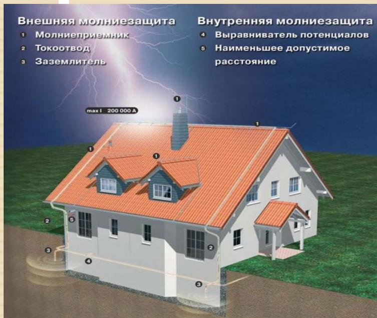
**Устройство молниезащиты** - система, позволяющая защитить здание или сооружение от воздействий молнии. Она включает в себя внешние и внутренние устройства. В частных случаях молниезащита может содержать только внешние или только внутренние устройства.
