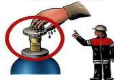
Отогревай замерзший трубопровод горячей водой или паром (открытым огнем - ЗАПРЕЩАЕТСЯ)
